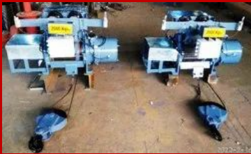
2 Ton 2 Fall Hoist
